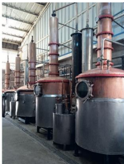
Figura 53, 54 y 55. Alambiques a gas (izquierda y centro) junto a alambique a leña (derecha) en desuso por búsqueda de métodos más sustentables. Pisquera Mal Paso, Hacienda Huamalata. Fotos: Carolina Cofré
