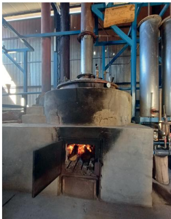
Figura 10. Destilación con fuego directo en la destilería Waqar, en Tulahuén. Foto: Sandra Montoya
