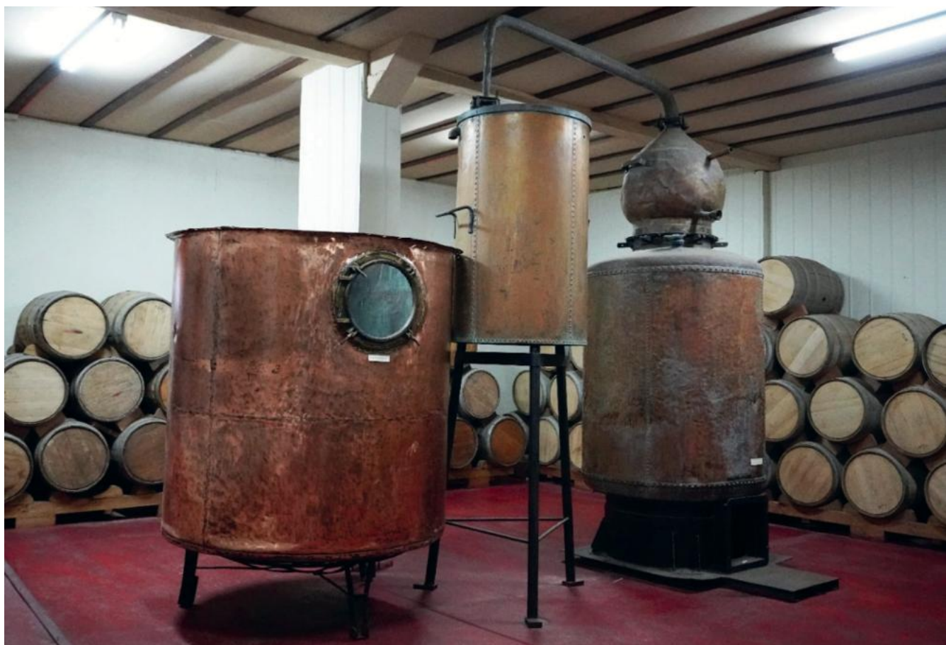
Figura 68. Alambiques artesanales de cobre labrado. Cooperativa Control Pisquero. Foto: Alexandra Kann
